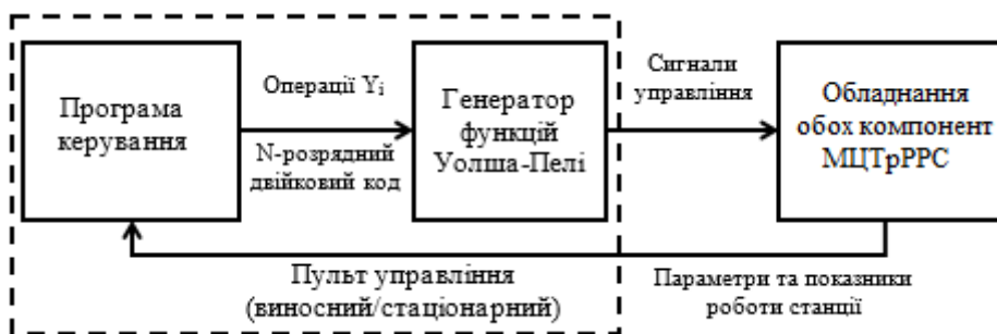
Рис. 7. Функціональна схема системи управління станцією МЦТрРРС
