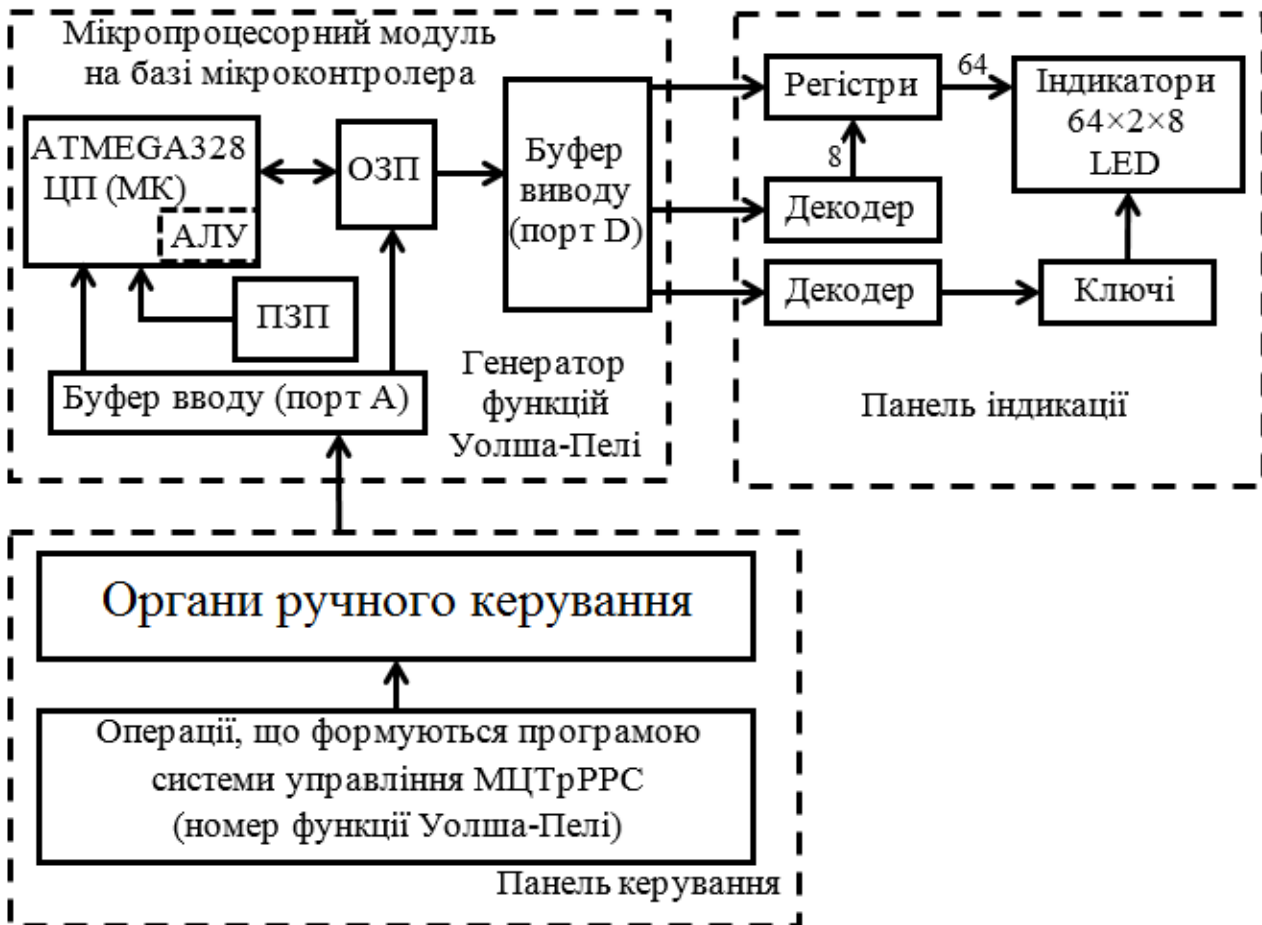
Рис. 9. Структурна схема діючого апаратно-програмного комплексу експериментального зразка пульта управління з генератором функцій Уолша-Пелі
