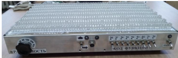
Рис. 10. Зовнішній вигляд діючого експериментального зразка пульта управління з генератором функцій Уолша-Пелі
